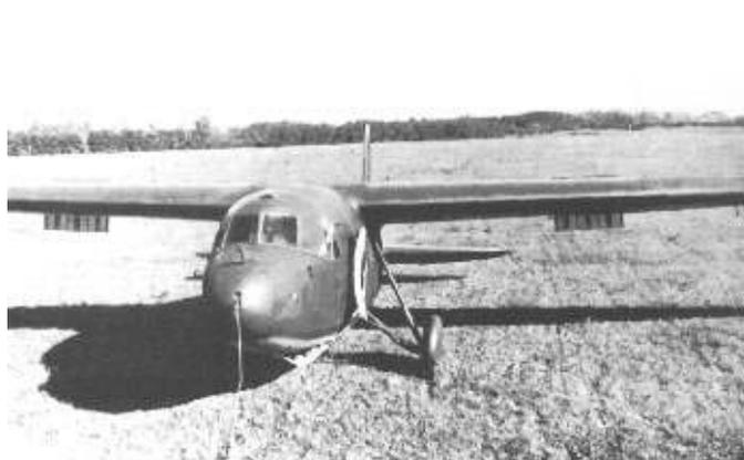
*Primo prototipo dell'AL 12 P MM508 pronto per il traino. Un particolare porta a ritenere possibile la realizzazione di una lieve modifica: sotto al muso, nel centro della fusoliera, si intravede quello che potrebbe essere un piccolo pattino, assente nelle foto di fabbrica che ritraggono l'MM 508*
